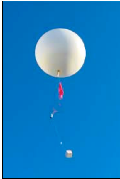
Fig.2 Treno di lancio Radiosondaggio
