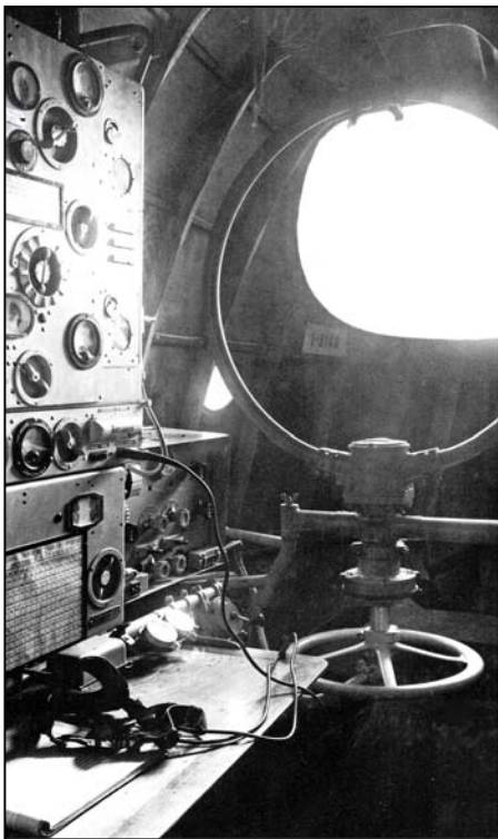
L'impianto radio e radiogoniometrico ad uso del marconista installato sull'S 55X.
