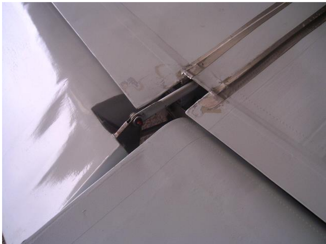
Terminale dell'asta che rinvia il movimento alla leva di comando dell'alettone (in corrispondenza della cerniera più vicina alla fusoliera).
