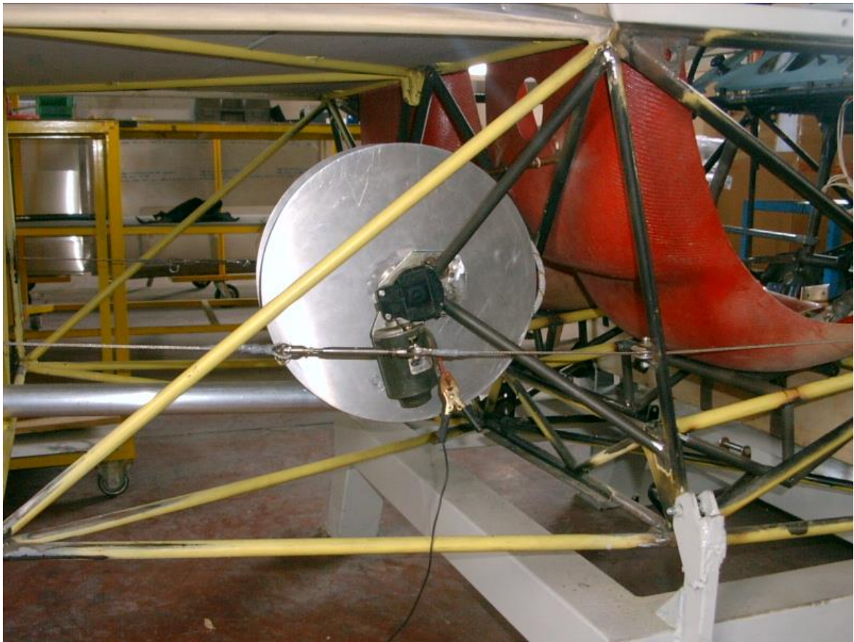
Verricello per il riavvolgimento del cavo di traino
