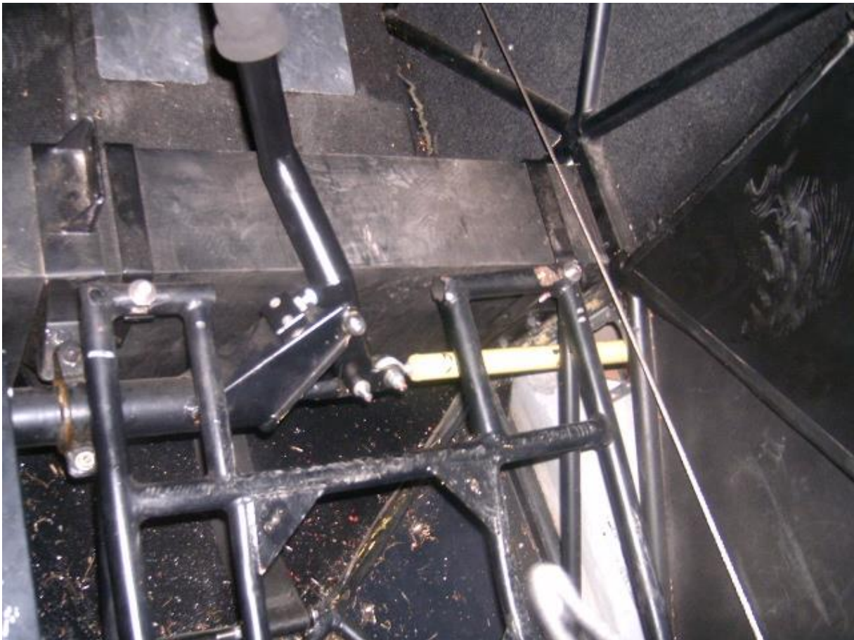
Cloche di destra; ben visibile l'asta per il comando degli alettoni che, una volta fuoriuscita dalla fusoliera, attraversa l'ala passando dietro il longherone
