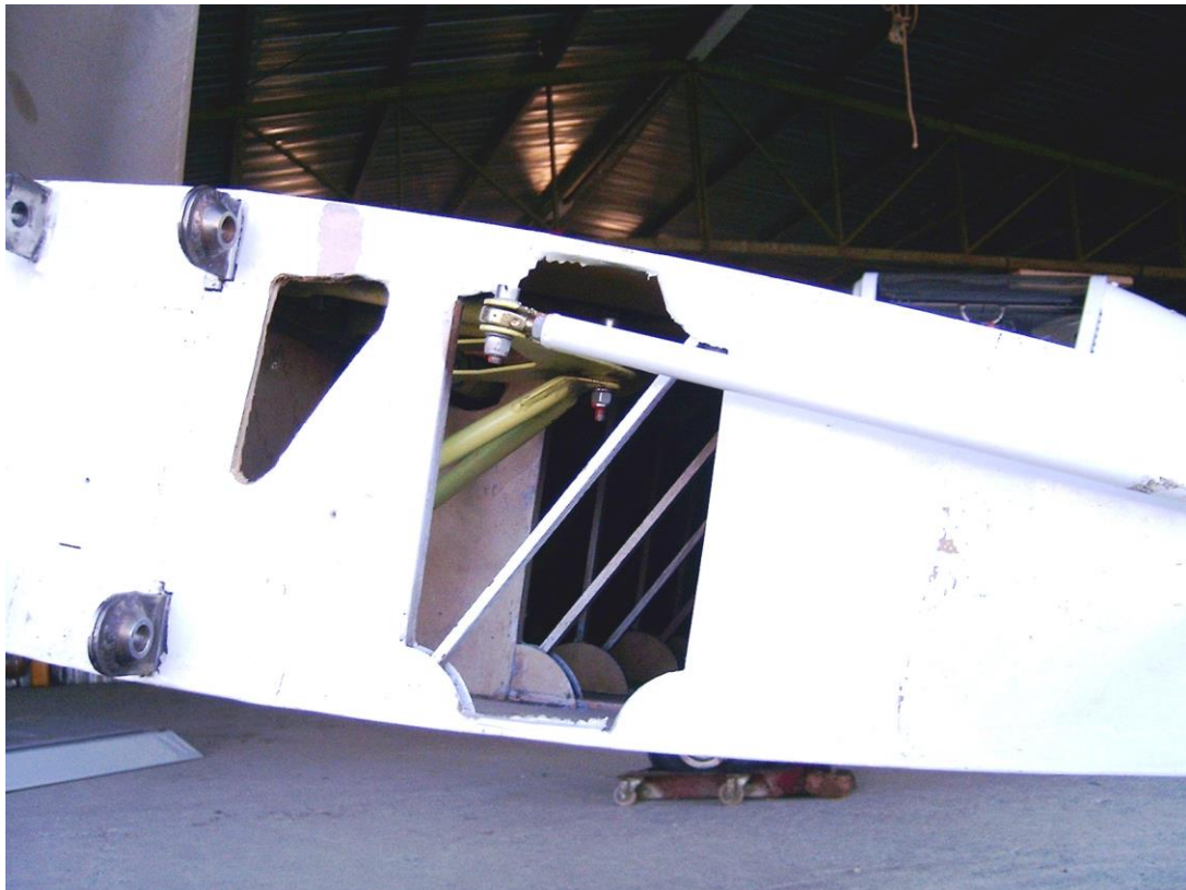
squadretta ed asta che rinvia il movimento alla leva di comando dell'alettone (in corrispondenza della cerniera più vicina alla fusoliera).
