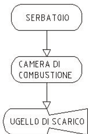
Fig. 23 - Schema di funzionamento di un pulsoreattore.
