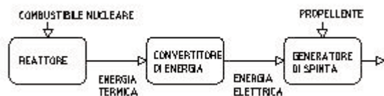
Fig. 35 - Schema di endoreattore avanzato nucleare diretto.
